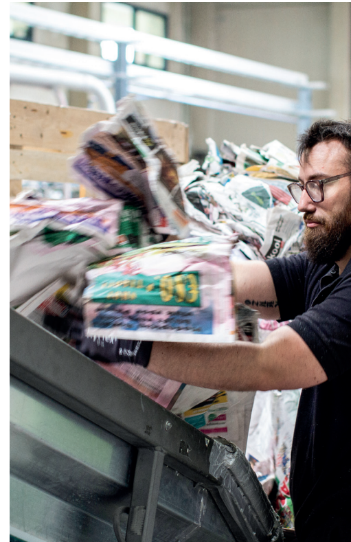
Oude, gerecycleerde kranten vormen de grondstof voor cellulosevlokken. © ISOPROC
