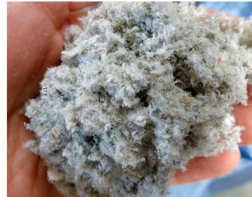
Cellulosevlokken worden gemaakt van resten krantenpapier. Ze zijn populair om hun uitstekende isolatiewaarde. iQ3-cellulose isolatie © ISOPROC
