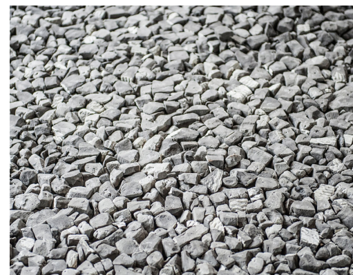
Glasgranulaten is een inert materiaal bestaande uit gerecycleerd glas. De granulaten kunnen onbeperkt hergebruikt worden. © Eurabo
